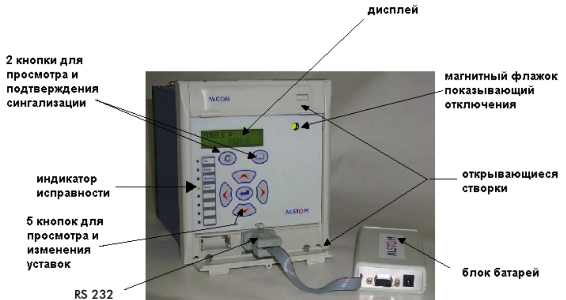
РИС. 2 MiCOM P124 с ПИТАНИЕМ ЧЕРЕЗ ПЕРЕДНЮЮ ПАНЕЛЬ
