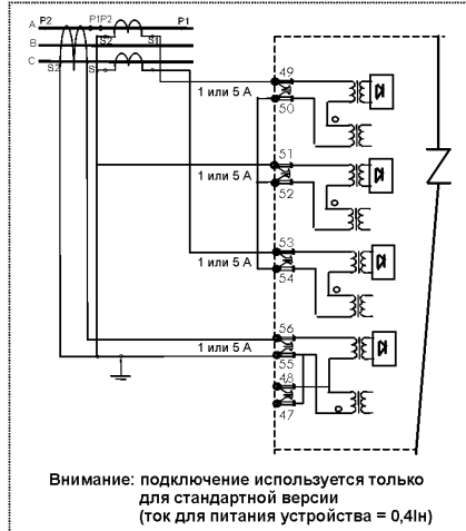
Вариант подключения на два фазных ТТ + ТТо
